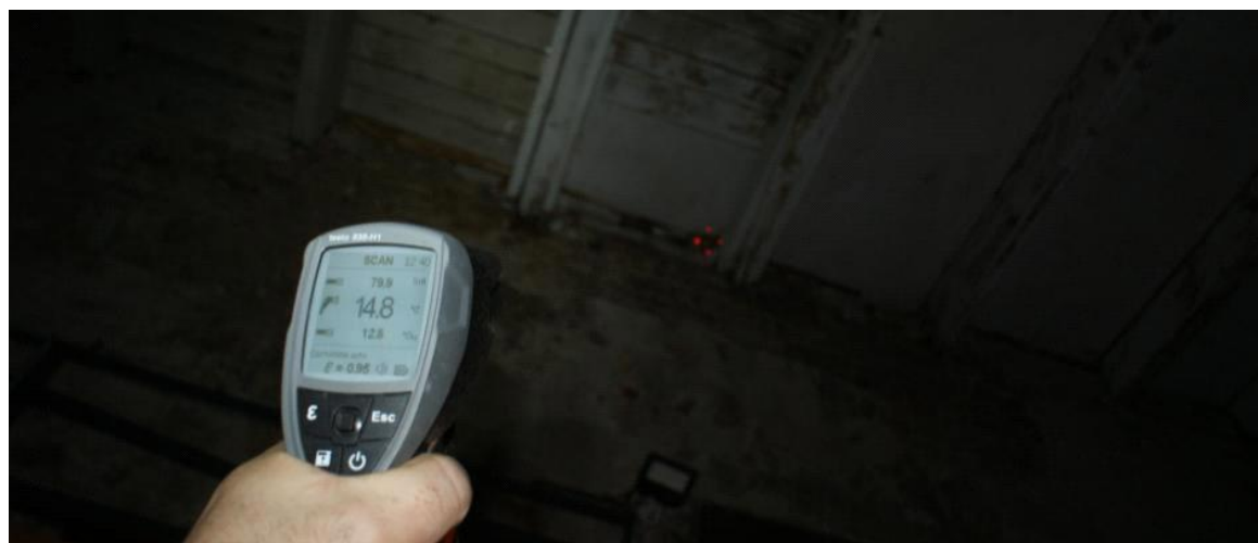
Pomiar punktu rosy na stropie magazynu.
